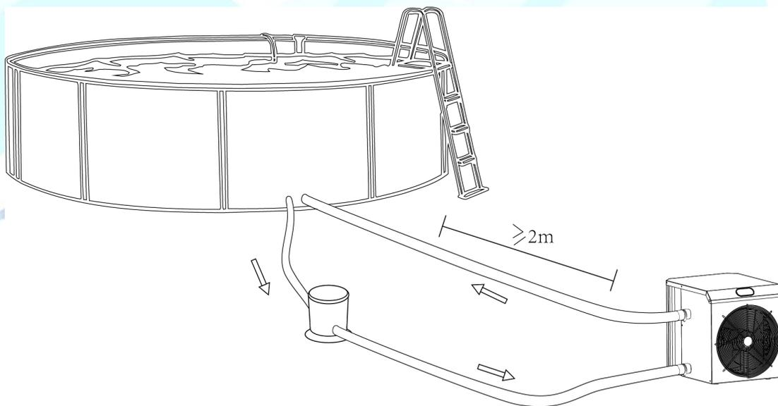
**ACHTUNG!** Die Wärmepumpe nie in einem geschlossenen oder nicht ausreichend ventilerten Raum installieren, oder auf einer Stelle, wo der Lufteinlass blockiert wird. Solche Standorte können den Luftdurchfluss beeinflussen und zu Rezirkulation der Luft führen, was die Effizienz der Wärmepumpe verringert und möglich zur völligen Abschaltung des Systems führt.
