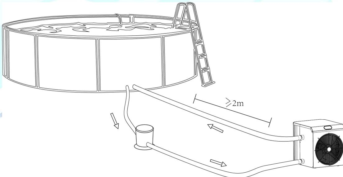
**LET OP!** Installeer de warmtepomp nooit in een afgesloten of onvoldoende geventileerde ruimte, of op een plaats waar de luchtinlaat wordt geblokkeerd. Deze locaties kunnen de toevoer van lucht beïnvloeden en leiden tot recirculatie van lucht, wat resulteert in een verminderde efficiëntie van de warmtepomp. Het kan zelfs het volledig stoppen van de warmtepomp veroorzaken.
